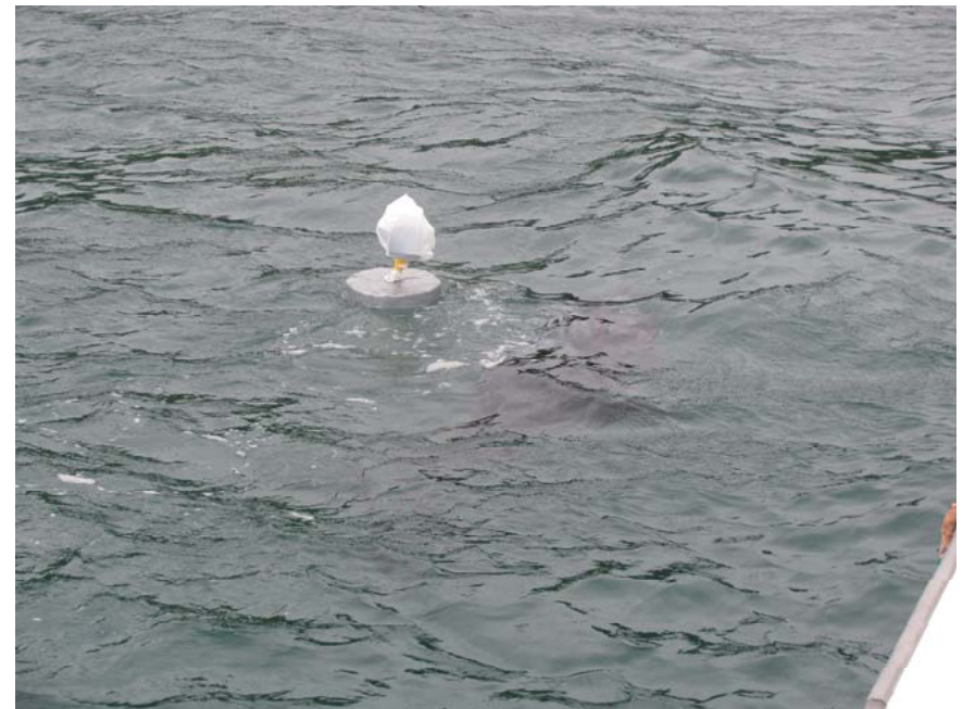
写真3 小型GPSデータロガーを装着した追従用ブイ （※追従用ブイの直下の黒い影はダイバー）
