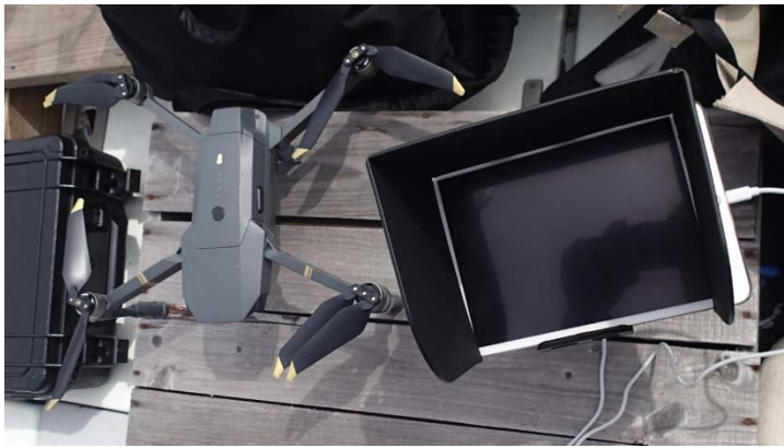
図 1. 4 使用機器ドローン (MAVIC PRO)
